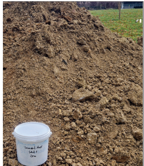
Abbildung 7: Foto Bodenaufschluss Schurf Nr. 1 mit Benennung der angetroffenen Bodenschichten und Bodenprobe 1
